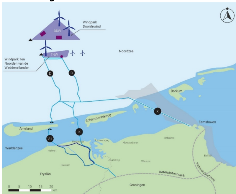
Figuur 3 Mogelijke routes voor aanlanding windgebied Ten Noorden van de Waddeneilanden (TNW) via waterstofroutes Ameland Wantij route (VIII), Zoutkamperlaag route (IX) en Tunnel route (X) met mogelijke bijbehorende landroutes en Noordzeeroutes (C) en (D).
