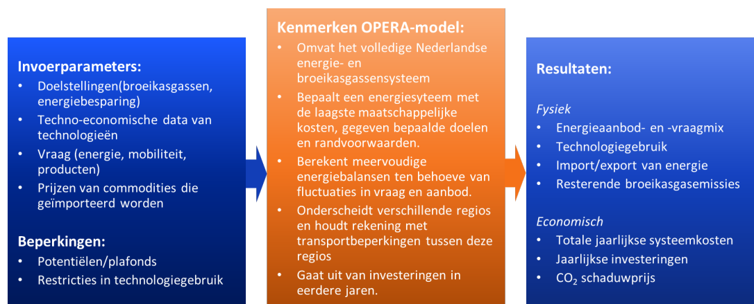
Figuur A.2: Schematische weergave van het OPERA-model
