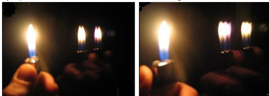
Afb. 2 Aantonen HR coating door verkleuring van de reflectie (links de derde reflectie, rechts de tweede)
