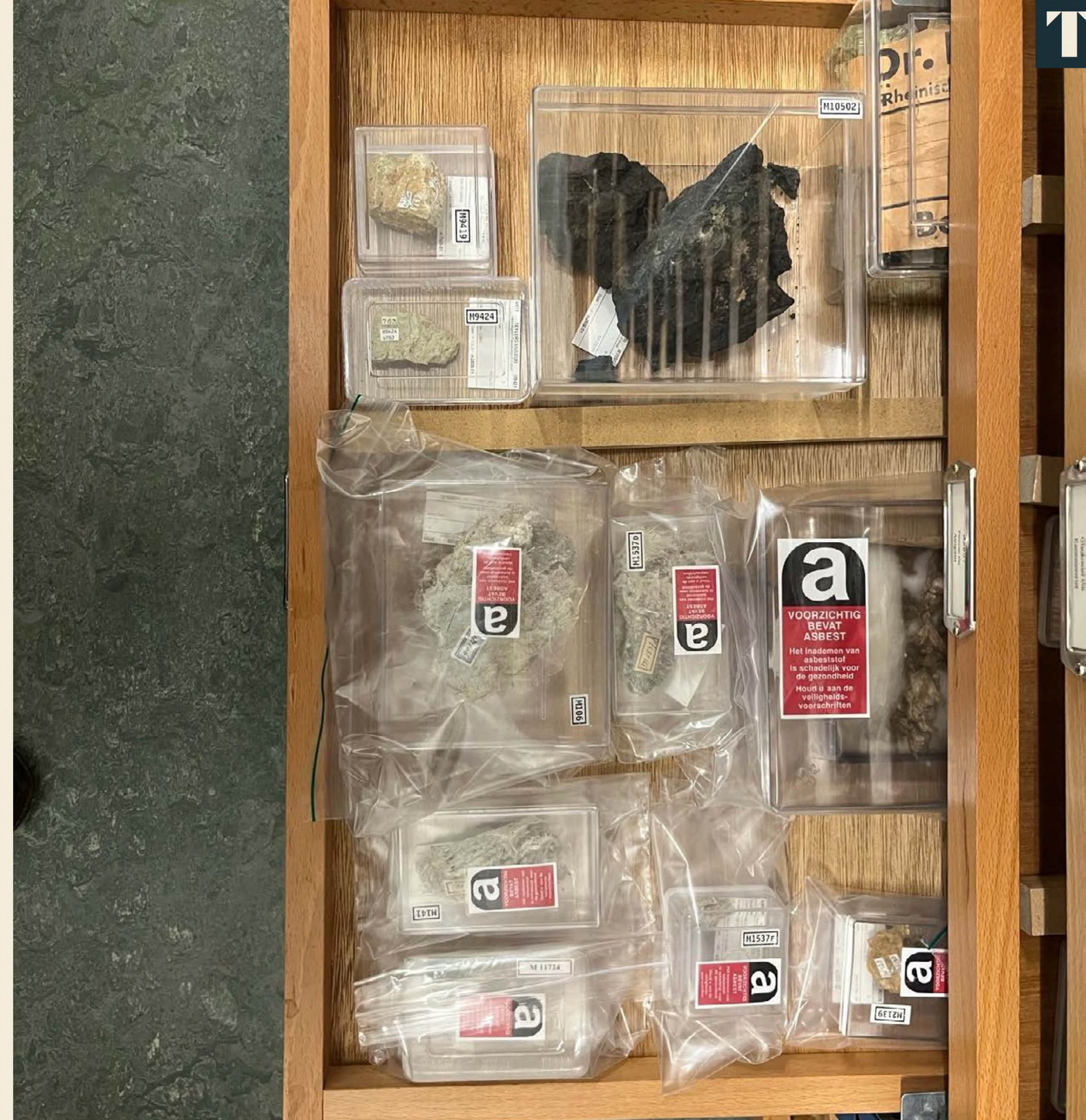
Veilig verpakte asbeststukken
