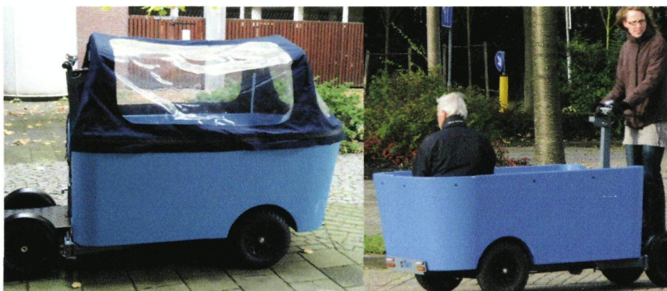
Afbeelding 1. De STINT tijdens een rijproef met en zonder overkapping.
