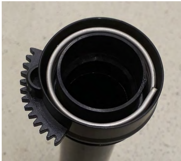
Figuur 17: Handvat met (gebroken) veer
