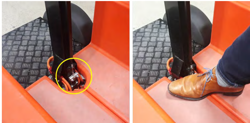
Figuur 11: Nieuw model Stint onbeschermd rembediening.
