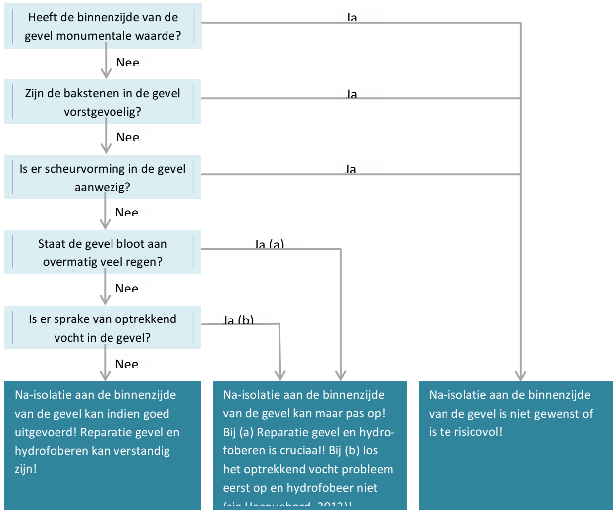
Figuur 5.1: Keuzeschema voor na-isolatie in de gevel 23
