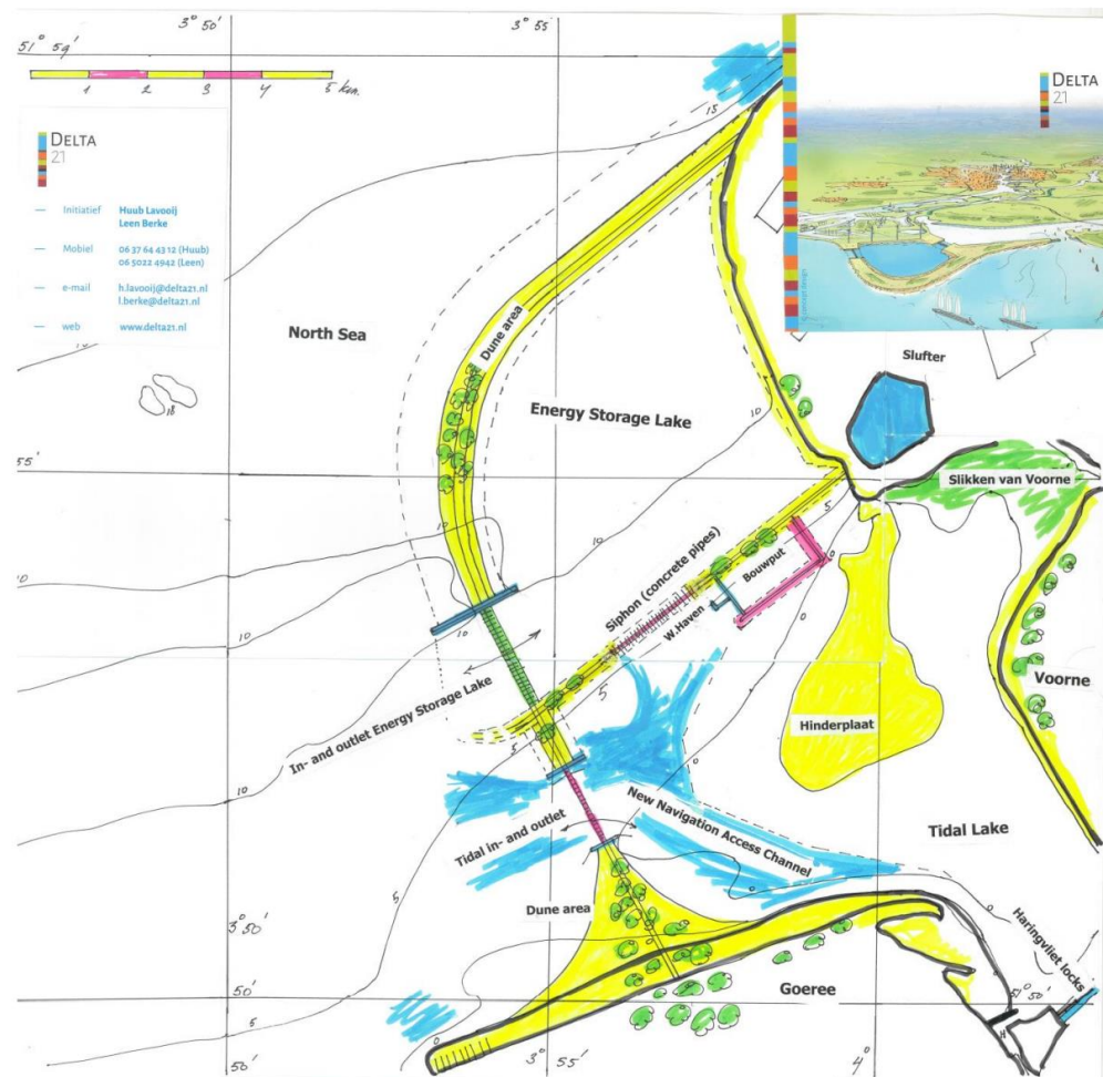
Figuur 6 Ontwerp van het Delta21-concept (Delta21, 2020)
