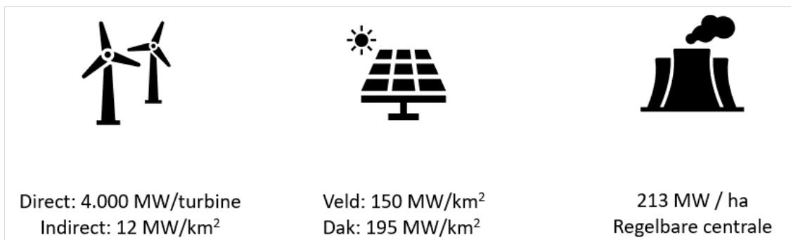
Figuur 2-1 - Overzicht ruimtegebruik opwek
