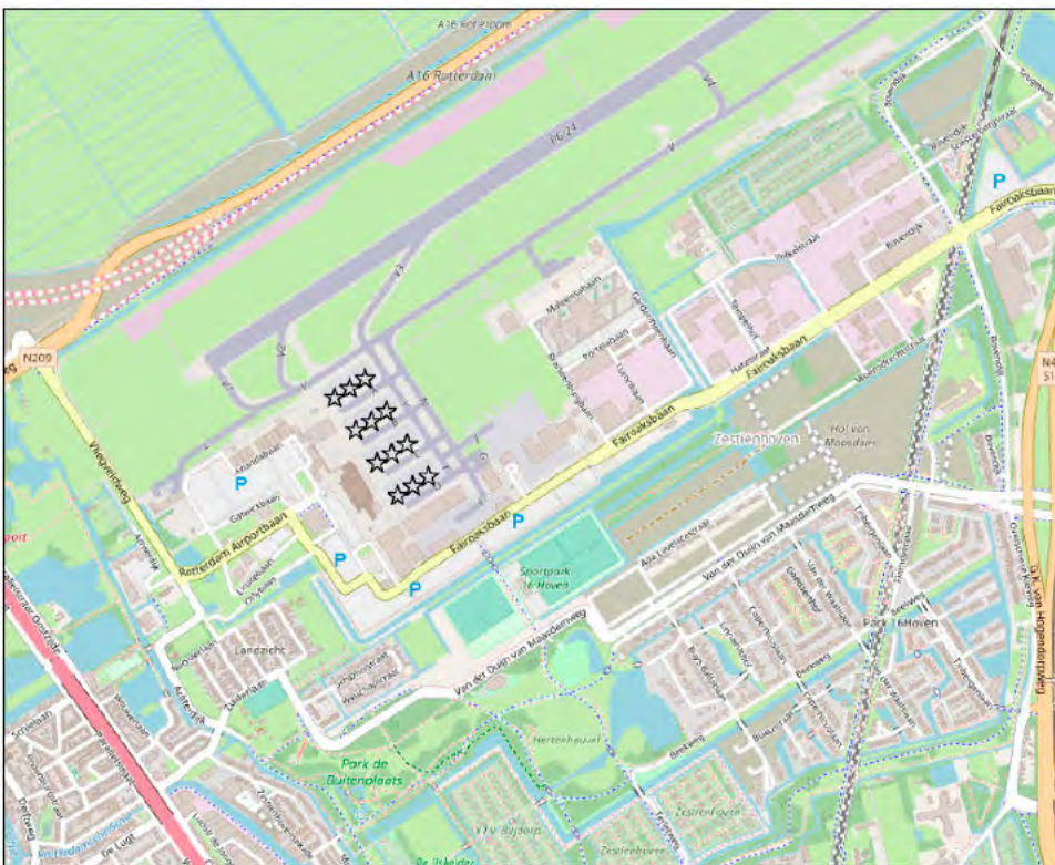
Figuur 32: Gebruikte APU emissielocaties op Rotterdam The Hague Airport. APU-locaties zijn gemarkeerd met een ster
