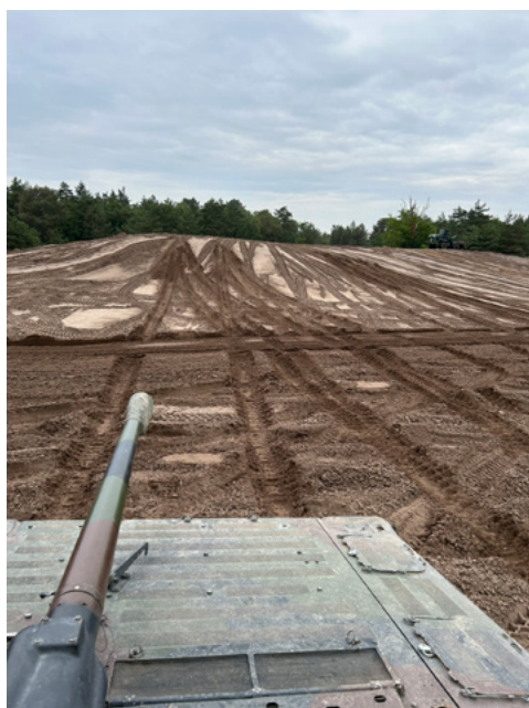
Afbeelding 2: CV90 OTCRij-indruksporen (foto IVD)
