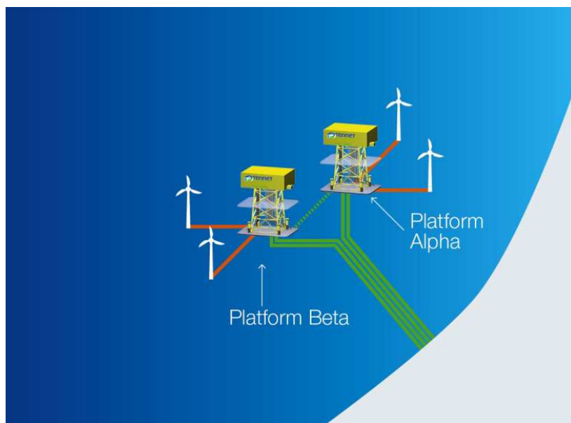
Figuur 2 Schematische weergave van concept van een net op zee.
