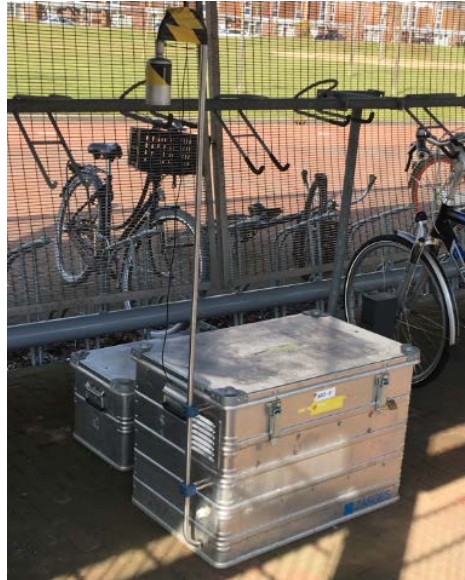
Figuur 24: Meetopstelling van de EPC in kist met inlaatsysteem duidelijk zichtbaar in dit geval op locatie Hoofddorp.
