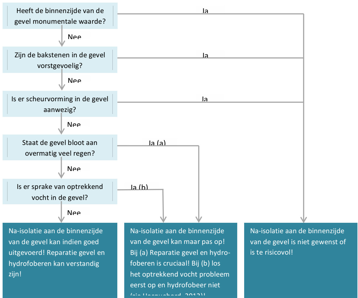
Figuur 5.1: Keuzeschema voor na-isolatie in de gevel 23
