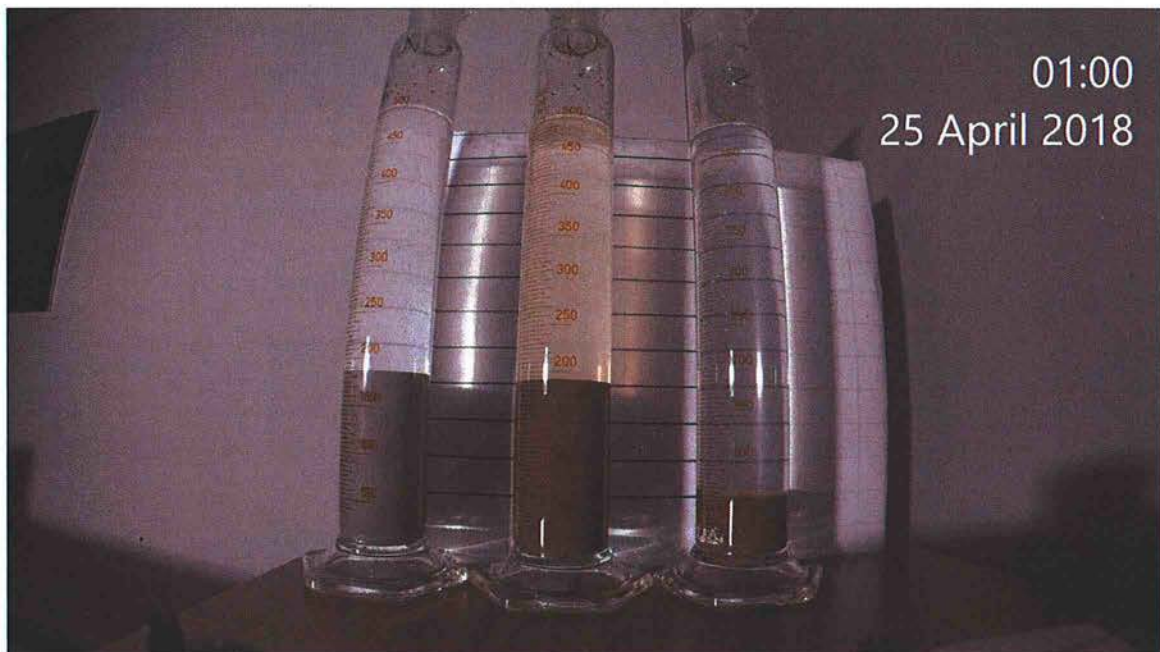
Figuur 4: Ongeveer 36 uur na het begin van bezinken. De helderheid van het water verandert bijna niet meer in de kolom met Noordse Leem en zand. De kolom met klei wordt in de volgende 13 uur (zie Figuur 5) iets helderder.
