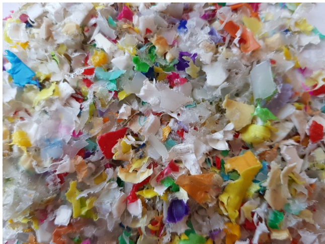
Figuur 3 Foto's van gewassen maalgoed, a. PET gewassen maalgoed, b. PP gewassen maalgoed, c. PE gewassen maalgoed
