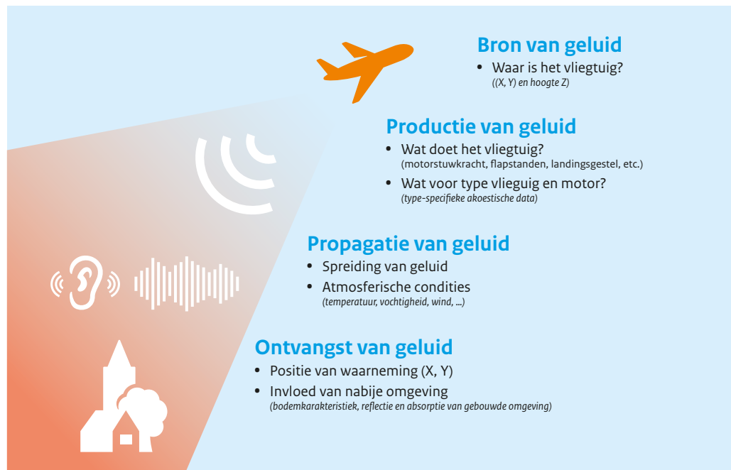
Figuur 4.2 Geluid van bron tot ontvanger
