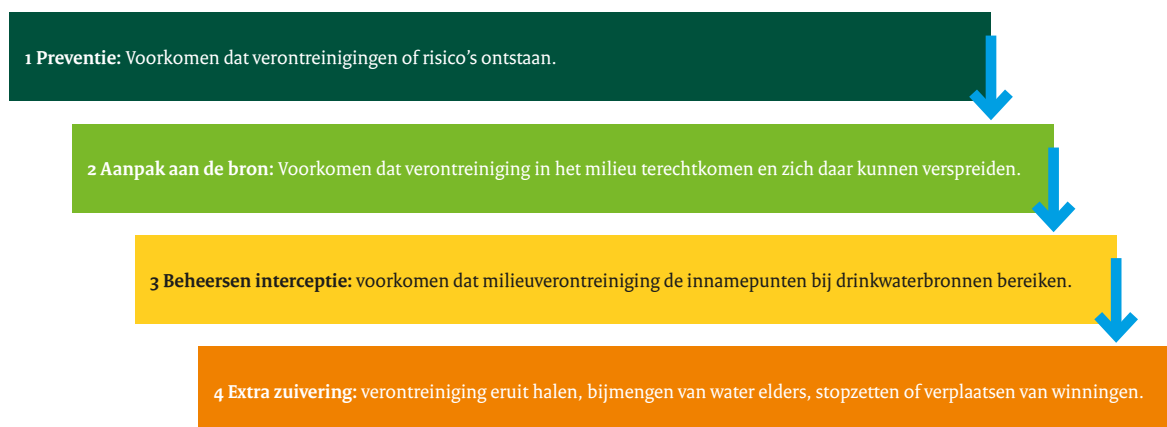
Figuur 3. Preventieladder voor de bescherming van drinkwaterbronnen
