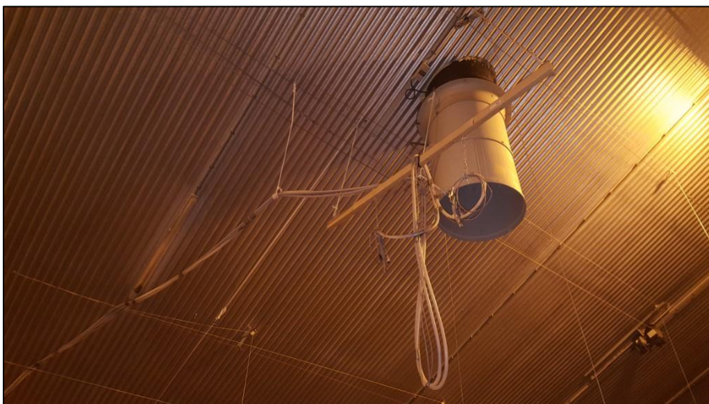
Oplierbare balk met monsternamaleidingen en ophangpunten voor meetapparatuur
