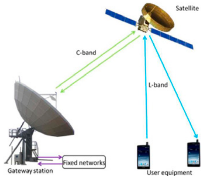
Figuur 1: Illustratie van NSV-communicatie via een satellietstelsel, uit TNO-rapport 2019 45
