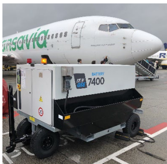
eGPU verzorgt stroom voor stationair vliegtuig zonder emissie
