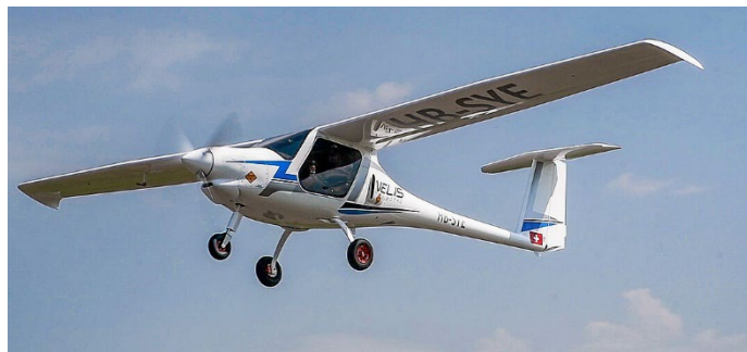
Pipistrel Velis Electric: operationele elektrische tweezitter
