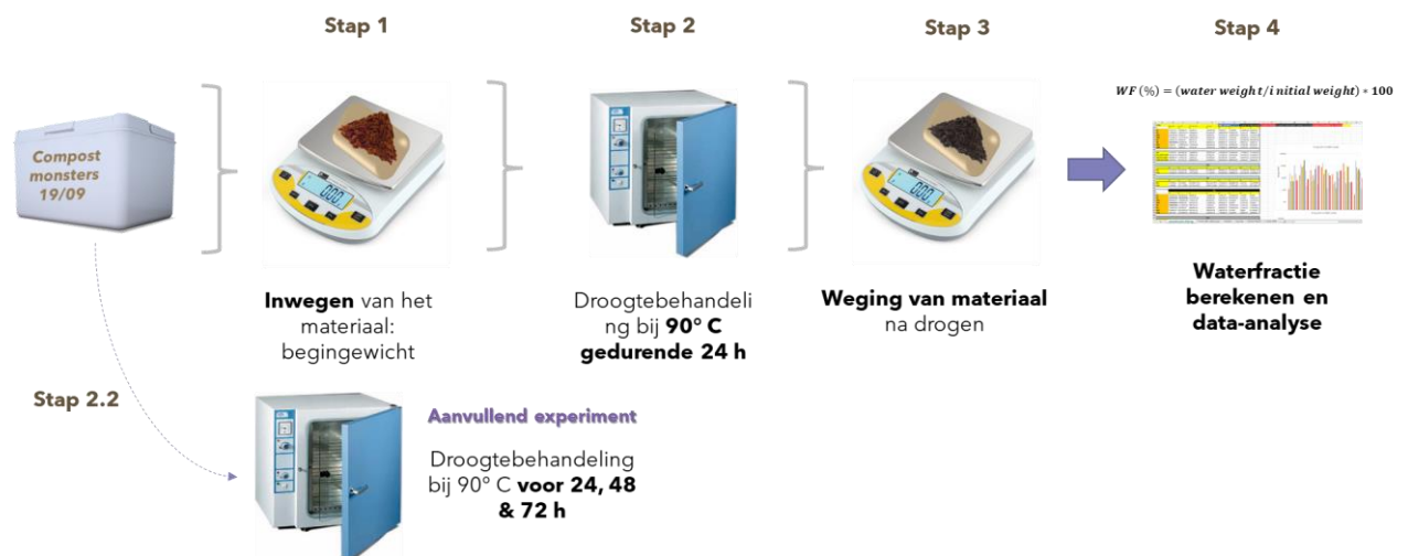
Figuur 4. Methodologie voor de schatting van de waterfractie via de 1L verzamelde monsters.
