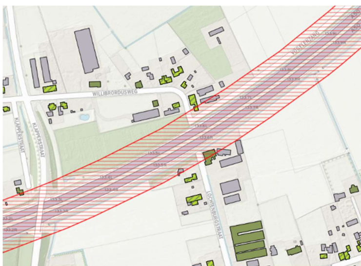
Afbeelding 10.2.3 Voorbeeld ligging (beperkt) kwetsbare objecten/gebouwen (groen) binnen PAG (rode arcering) bij Schaijk.
