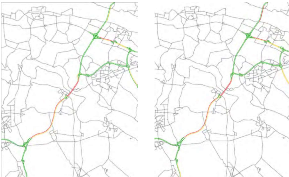
Figuur 2.2: I/C verhoudingen ochtendspits (links) en avondspits (rechts) op basis van NRM-oost 2018 (basisjaar)
