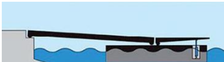
Afbeelding 2.19 Floating linkspan ponton [ref. 4]
