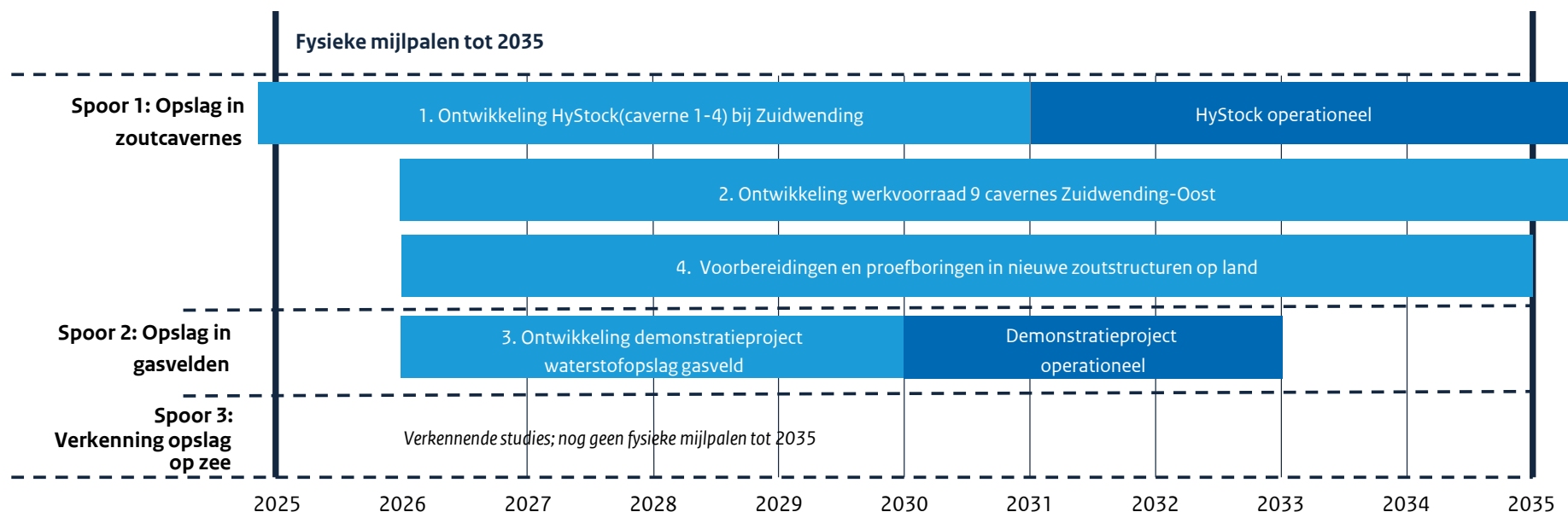
Figuur 19: Tot 2035 wordt toegewerkt naar een aantal mijlpalen voor ondergrondse waterstofopslag.
