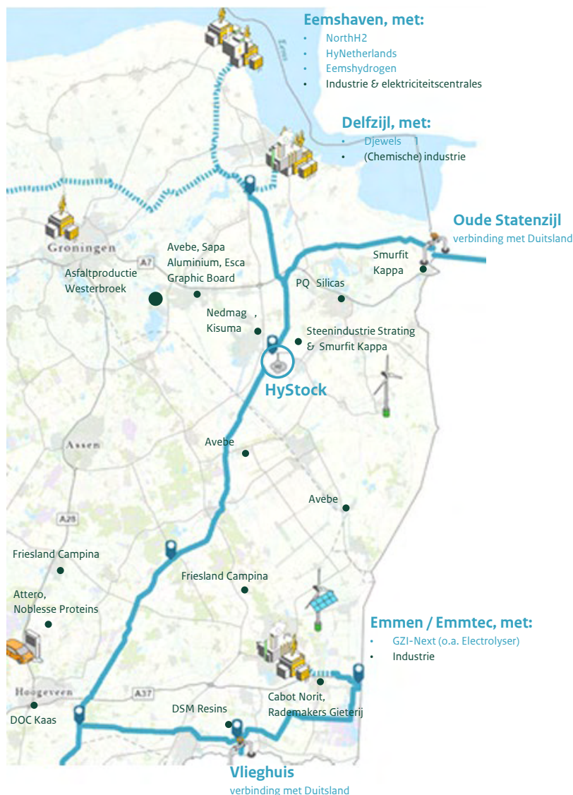
Figuur 16: Ligging van het beoogde waterstoftransportnetwerk, produceren van waterstof, en grotere industriegebieden (bron: (Industrietafel Noord-Nederland, 2022), aangepast ten behoeve van dit document).
