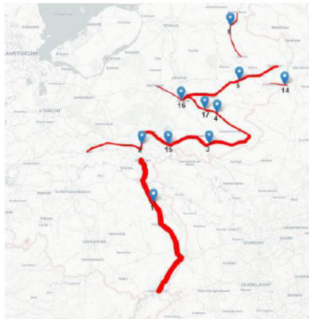
Figuur 3 | Visualisatie (1/2) van de verschillende lijnen waar met dieselmaterieel gereden wordt (Oost-Nederland). De dikte van de lijn geeft de relatieve CO 2 -emissies weer.
